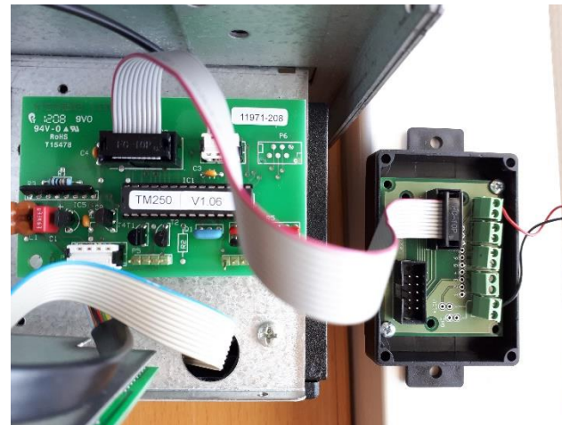
Bild 2 , Befintlig bandkabel ersätts med medföljande kabel, som ansluts till "Outgoing" på adaptern.
